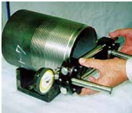
测量螺纹直径
